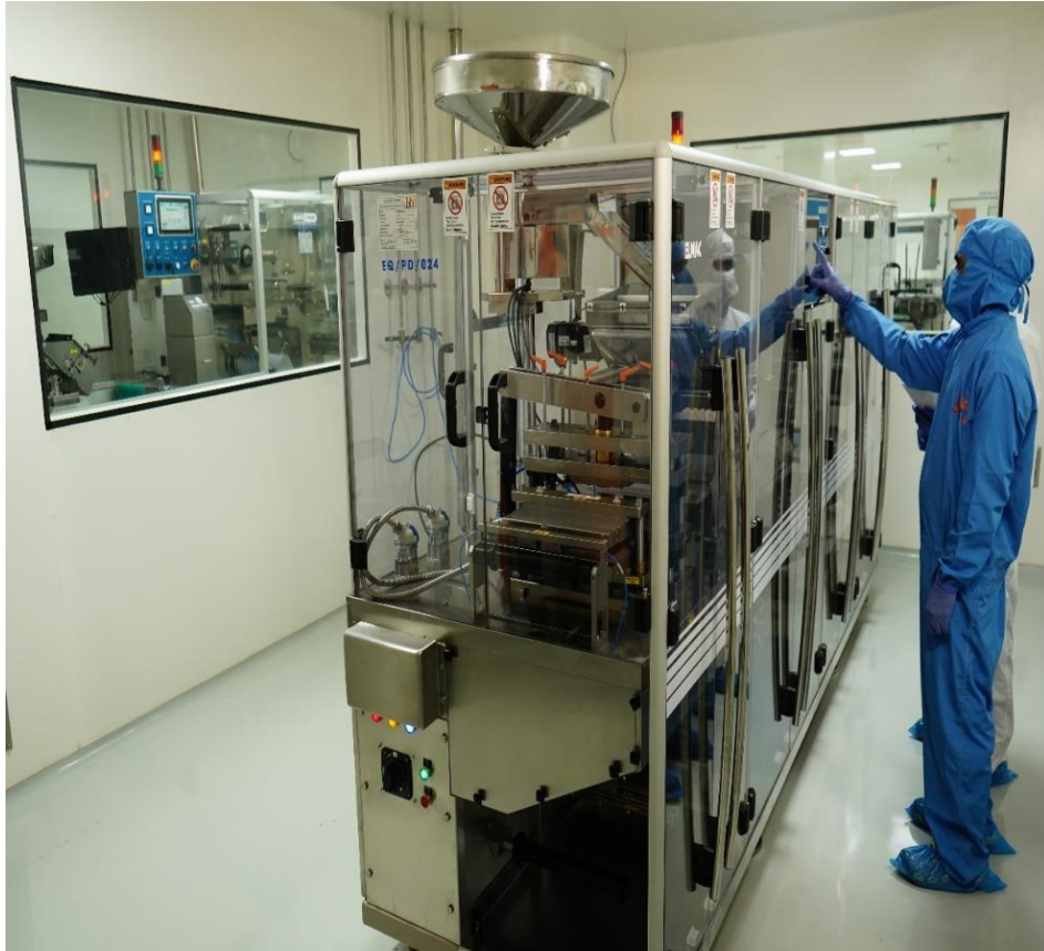
ALU ALU Packing Machine with BIS
